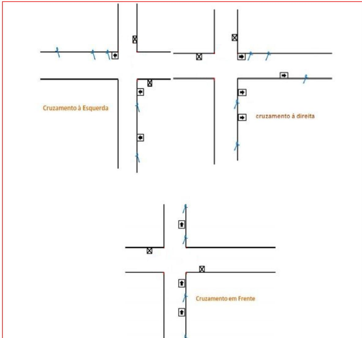
Nas curvas à direita, as fitas serão colocadas antes das curvas à direita e dentro destas à esquerda, sendo colocadas novamente à direita a seguir à curva.
